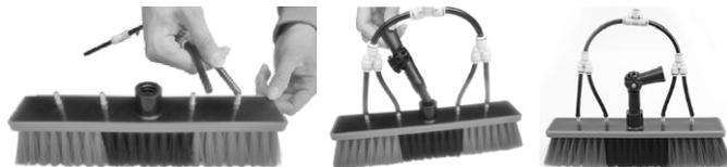
A seguir, conecte o adaptador de ângulo no encaixe principal rosqueando-o. O próximo passo será a montagem da haste, insira a mangueira no orifício da base da haste, e ao final da haste, na parte frontal, passe a mangueira pelo orifício lateral, se necessário utilize a chave hexagonal para auxiliar a retirada da mangueira, puxe-a para fora o suficiente para manuseio e encaixe no plugue T já instalado na base da vassoura.
