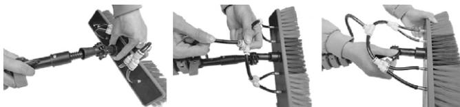
Conecte as mangueiras principais com o uso dos conectores de engate rápido (conector de cobre, plástico e tipo registro).
