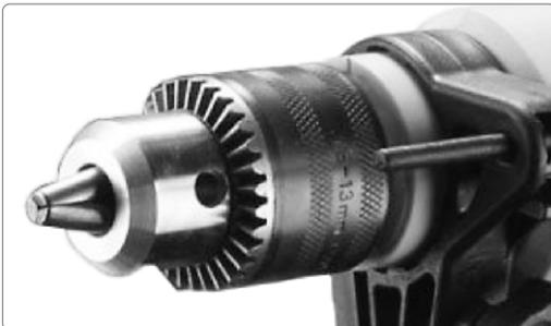
possui muito pó e resíduos dentro do mandril. Abra o mandril. Aplique um desengripante\* dentro do mandril. \*item não incluso Caso verifique um excesso limpe o interior com um pano ou flanela. Abra e feche o mandril algumas vezes para fazer o desengripante circular no mandril.
